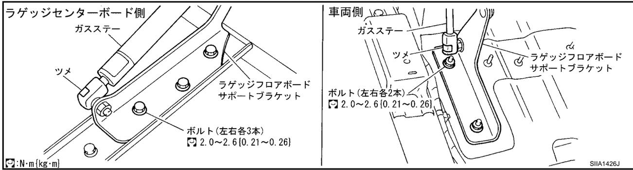
参考：ガスステーの取り外しは、ガスステー両端の爪をマイナスドライバー等で外し、ラゲッジサポートブラケットより引き抜く。
