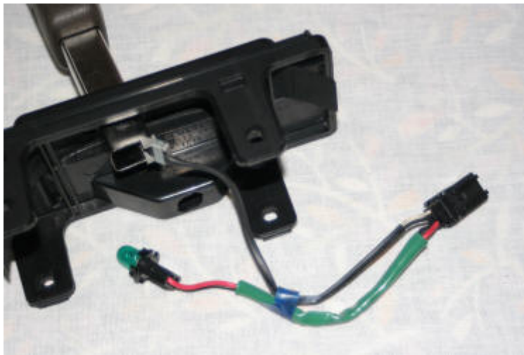
A/Tセレクトレバーの下側の配線 A/Tインジケータイルミネーションランプの電球は3.4W、200mA(緑色のカバー付き)
