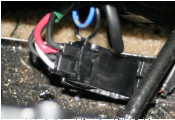
コネクタのオス端子につながっているコード側から撮ったもの 白コード=橙コード、赤コード=青コードに対応している
