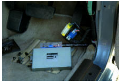
A/Tコントロールユニット ここに眠っている故障情報を引き出すのが自己診断機能
