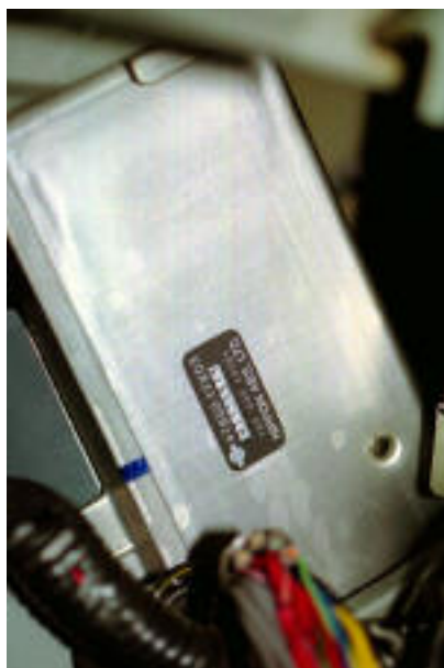
トランクルーム左側にある4WASモジュール 47850-17V03 NIPPON ABS.LTD. (右下の丸い穴がインジケータ)
