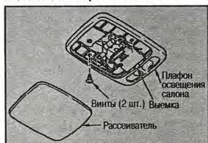
Лампа плафона освещения салона: 12V - 10 Вт
